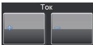
Циклограмма запущена: нажатие на одну из кнопок «Ток» позволяет изменить значение коррекции тока сварки п. 1.6.9.1.
